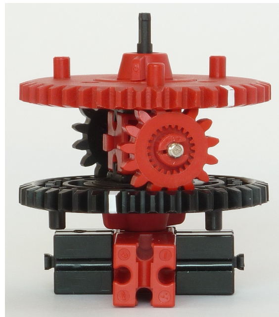
Abb. 15: Allgemeiner Zustand des Differentialgetriebes
