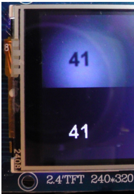
Abb. 8: Ansicht des Originalbildes (oben) und des Bildes nach dem Schwellwertfilter (unten)
