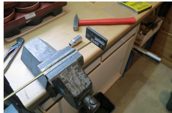
Abb. 2: Runddrücken des I-Profils
