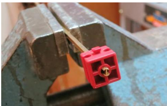
Abb. 4: Profil in Baustein 15 mit Bohrung
