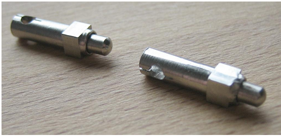
Abb. 3: Zwei Federkontakte des Drehschalters
