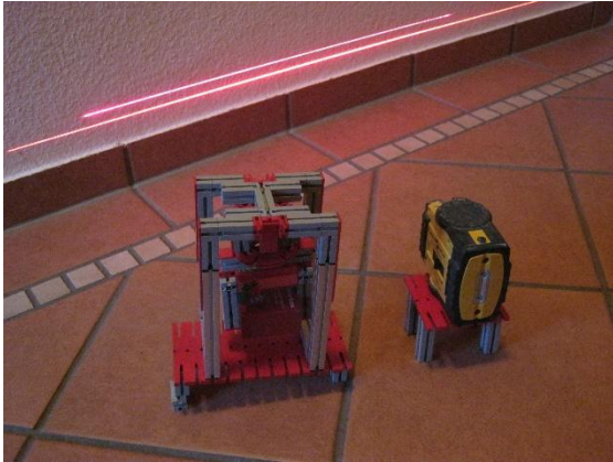
Abb. 3: Einsatz eines professionellen Laser-Nivelliergerätes zum Vergleich mit dem fischertechnik-Aufbau, schief aufgestellt
