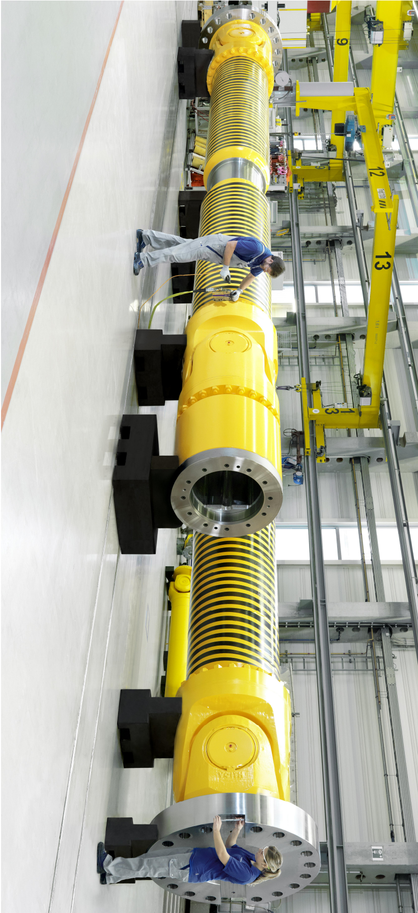
Abb. 18: Hochleistungs-Gelenkwelle © Voith Turbo GmbH & Co. KG [5]
