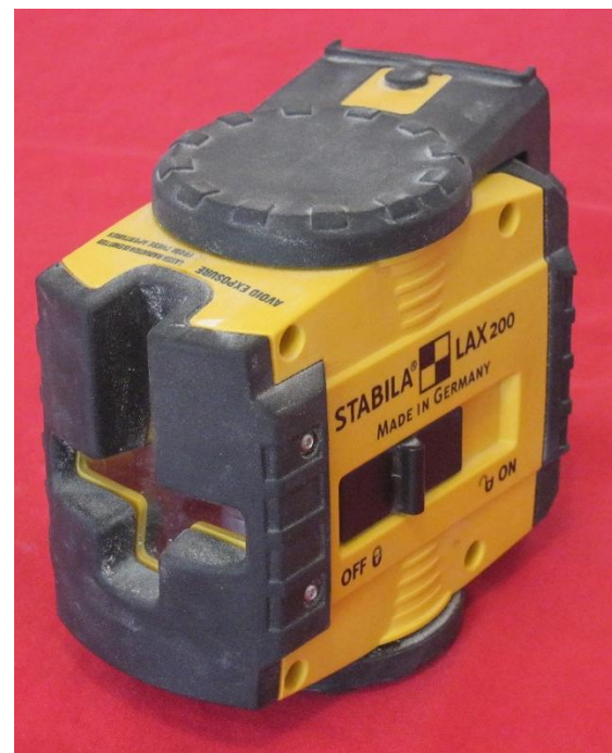
Abb. 2: Laser-Nivelliergerät, hier in der Variante eines Kreuzlinienlasers
